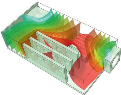
Abaqus/CFD ermöglicht die Berechnung der Kühlung von Elektronikbauteilen, hier gezeigt am Temperaturverlauf (Isoflächen) einer Leiterplatte.
