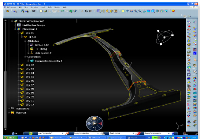
Automatische Lagenerstellung mit zonenbasiertem Ansatz
